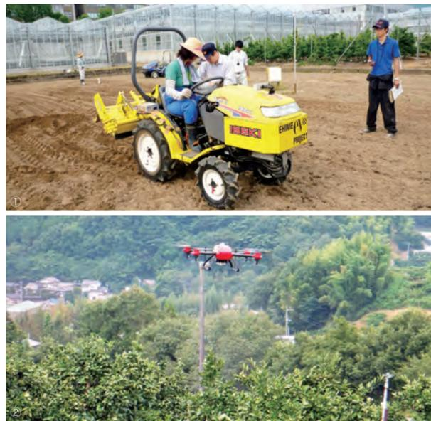
▲①企業・愛媛県と共同開発した電気トラクタの実験 ②急傾斜柑橘園でのドローンによる農業散布
